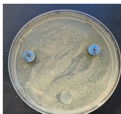
Рисунок 2 - Покрытия Ta-Cu на дисках из сплава Ti-6Al-4V и контрольном полипропиленовом диске в питательном растворе S. Aureus (а) и C. Albicans (б)
